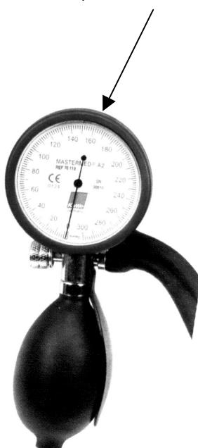
Slika 1: Fotografija tlakomjera za krvni tlak tip Mastermed A1 s prikazom mjesta za smještaj ovjerne naljepnice
